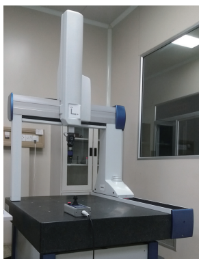
图2 非接触式的光学扫描测量系统 Fig.2 Non-contact optical scanning system
